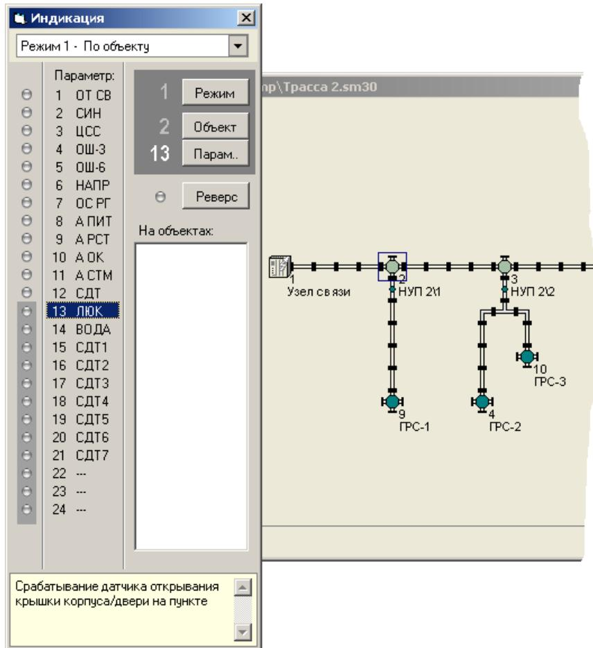
Назначение этого окна – индикация состояния трассы и сигнализация в нескольких режимах с возможностью выбора параметра просмотра.
