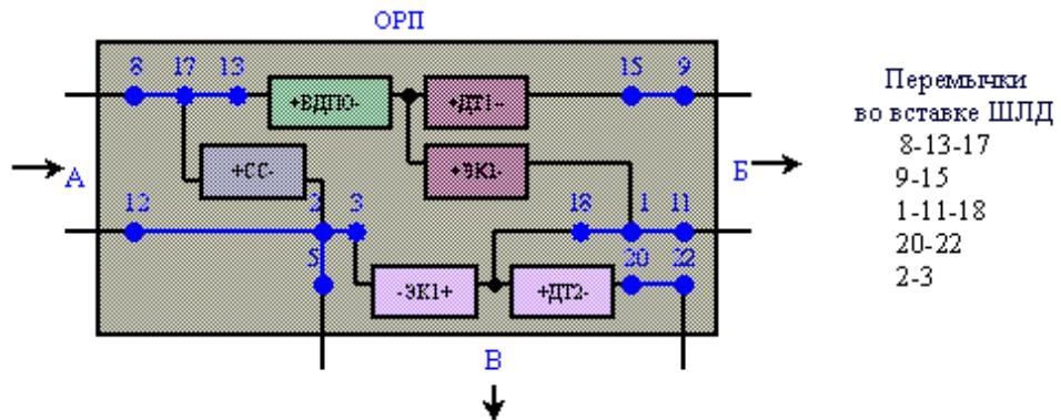
10. С направления Б в направление А при отсутствии ячейки ВДПР с включением дополнительного шлейфа по направлению В (Т-образная схема)
