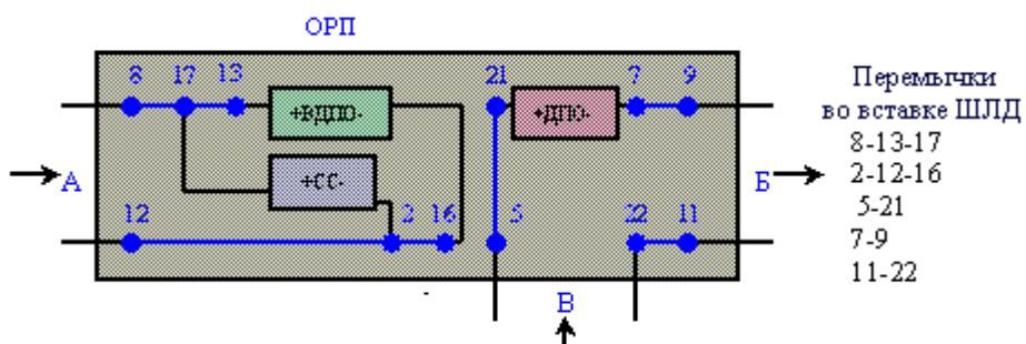
9. С направления А в направление Б при отсутствии ячейки ВДПР с включением дополнительного шлейфа по направлению В (Т-образная схема)
