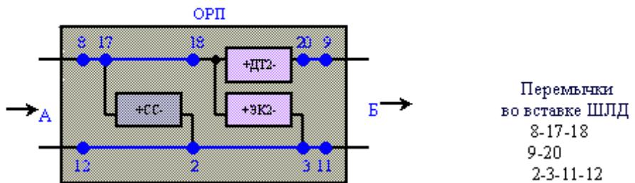
13. С направления В в направление Б без запитывания оборудования ОРП током ДП (при питании от БВУ-М-А) с установкой дополнительного шлейфа и датчика ответвления по ДП с направления А
