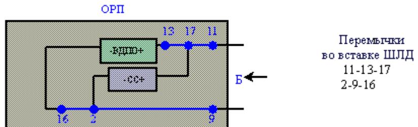
5. С направления А в направление Б при отсутствии ячейки ВДПР и схемы автоматической установки шлейфа
