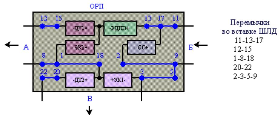
11. С направления В в направление А при отсутствии ячейки ВДПР с включением дополнительного шлейфа по направлению Б (Т-образная схема)
