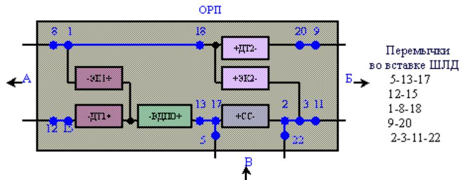
12. С направления А в направление Б без запитывания оборудования ОРП током ДП (при питании от БВУ-М-А) с установкой дополнительного шлейфа
