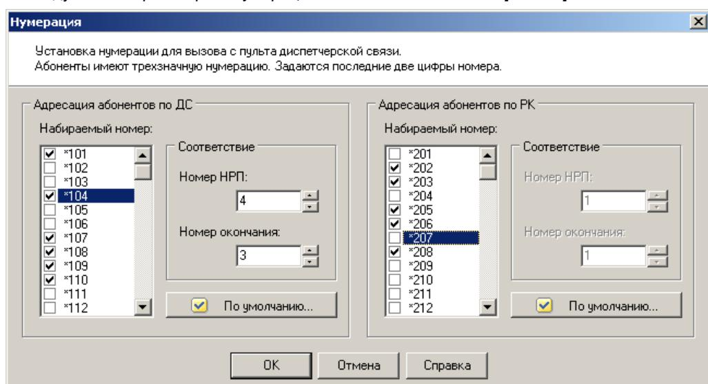
Каждому набираемому номеру ставится в соответствие номер НРП (адрес объекта) и номер окончания. Номер окончания – порядковый номер в окне *Параметры объекта*, вкладка *Окончания*.
