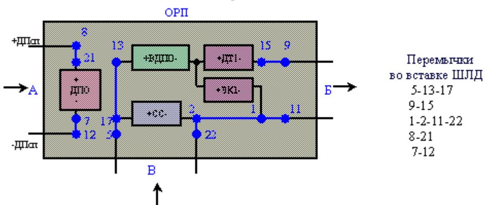
8. С направления А в режиме окончания ДП и при отсутствии ячейки ВДПР, с организацией транзита ДП с направления В на Б с включением датчика ответвления по ДП
